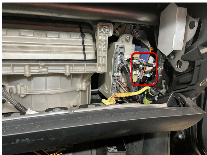
Подключение производится в белом разьеме крайнего черно-оранжевого блока за передаточным ящиком
