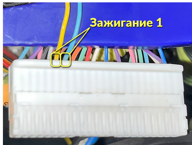
Подключение к цепям запуска: Зажигание 1 – голубой провод, контакт № 34 «+»; Зажигание 1 – желтый провод, контакт № 35 «+».
