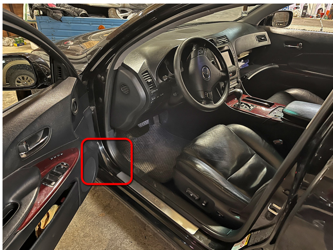
Подключение производится в белом верхнем разьеме за левой кик-панелью
