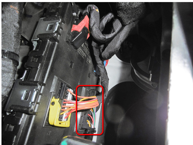
Подключение стартера осуществляется в нижнем черном 52-контактном разъеме блока BCM, за левой кик-панелью
