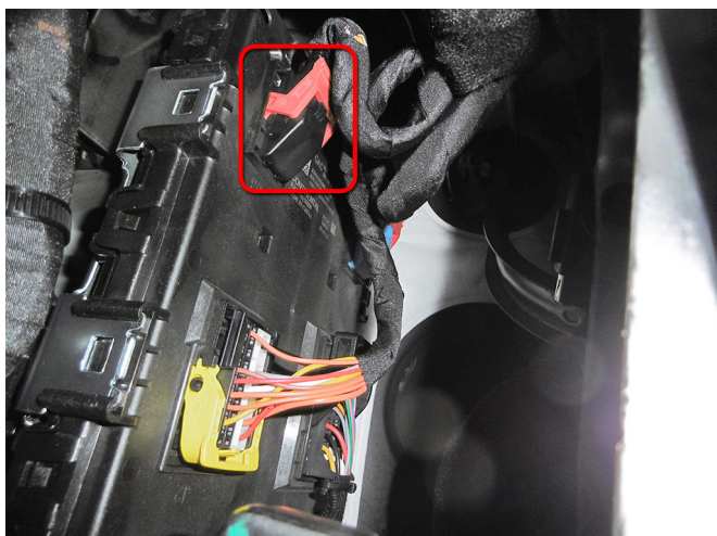
Подключение аксессуаров осуществляется в черном 25-контактном разъеме блока ВСМ, за левой кик-панелью
