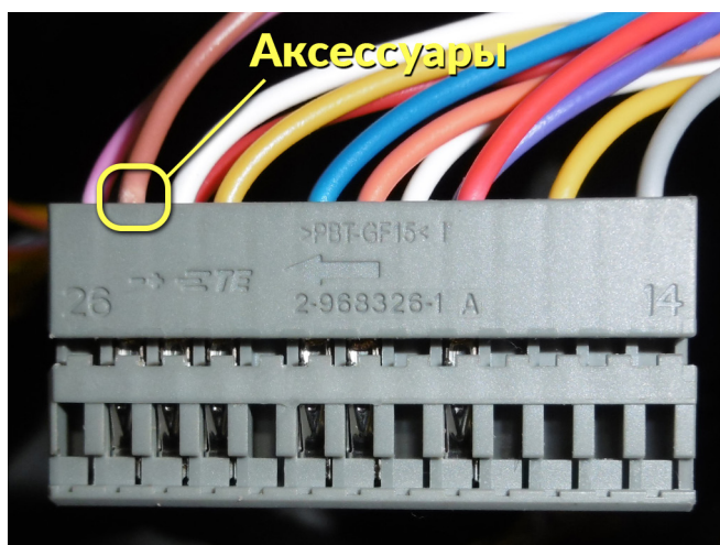
Подключение к цепям запуска двигателя: Аксессуары – коричневый провод, контакт № 25 «+»
