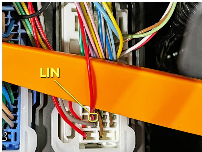
Подключение к шине данных: LIN – красный провод, контакт № 33.
