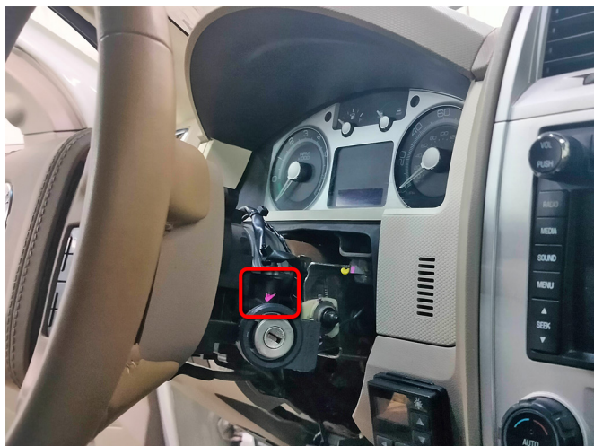
Черный 4-контактный разъем иммобилайзера на рулевой колонке
