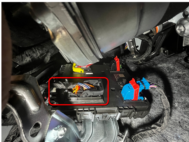
Подключение аксессуаров осуществляется в черном 52-контактном разъеме блока BCM, слева от рулевой колонки
