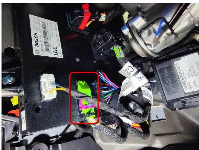
Зеленый 32-контактный разъем блока BCM, слева от рулевой колонки
