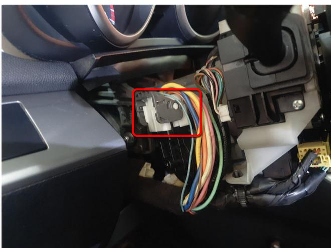
Белый 8-контактный разъем замка зажигания слева на рулевой колонке
